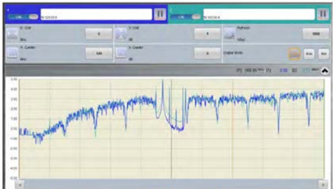
Módems con inclinación extrema en la pantalla de la aplicación Remote Spectrum
